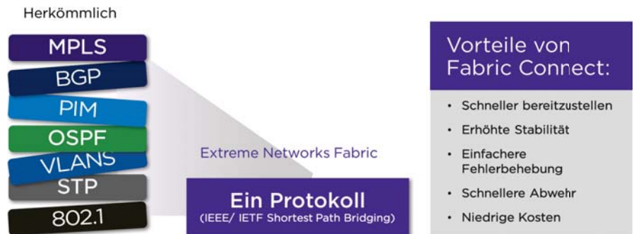
Abbildung 3: Fabric-Verbindung vereinfacht das Netzwerk
