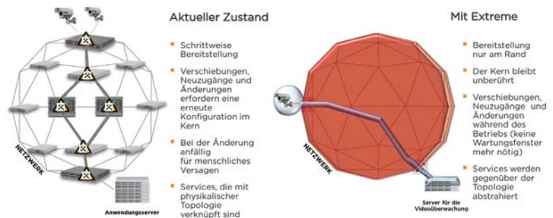
Abbildung 2: Fabric-Verbindung beseitigt Berührungspunkte
